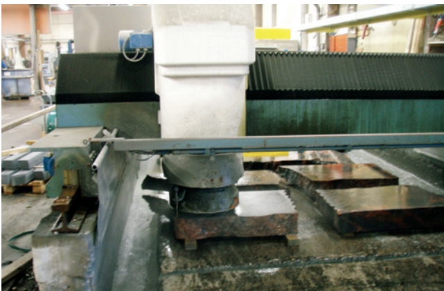
Kuva 25. Kivilevyn kiillotusta tasohiomakoneella.
