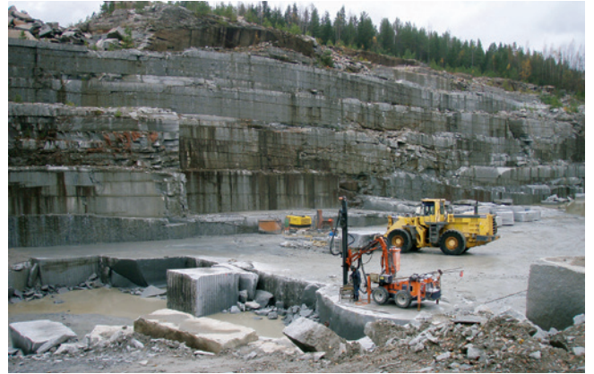
Kuva 14. Selvästi erottuvat vaakalustat kurulaisesa louhimossa.
