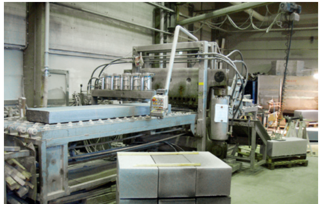
Kuva 26. Kivilevyn leikkausta hydraulisella puristimella.
