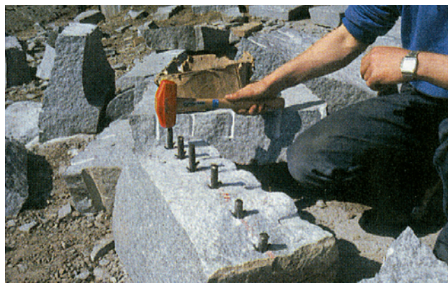
Kuva 18. Kiven halkaisu kiilaamalla
