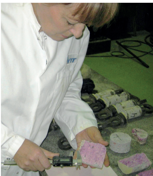
Kuva 2. Karbonatisoitumisen mittaus poranäytteistä.
