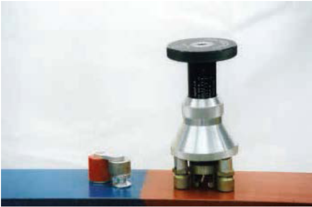
Kuva 63. Tartuntamittauksessa käytettävä vetolaite
