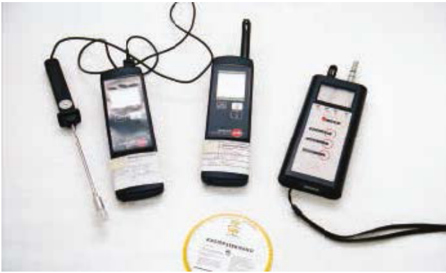
Kuva 58. Pintalämpömittari, pinta- ja ilmalämpömittari, yhdistelmämittari, jossa on lämpömittarien lisäksi kastepistelämpötila (°C) ja suhteellinen kosteus (RH %), alimpana kastepistekiekkko
