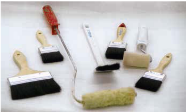
Kuva 48. Siveltimet ja telat, jotka soveltuvat eri maalikerrosten maalaamiseen ja vahvennusmaalaukseen
