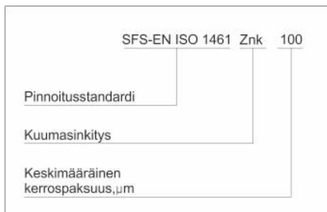
Kuva 18. Kuumasinkityksen merkintä ja sen tulkinta
