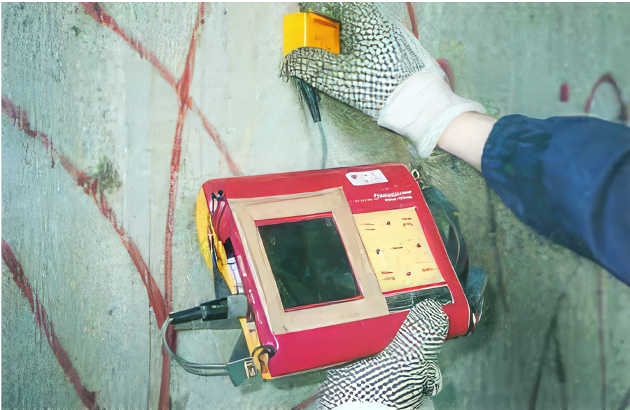
Kuva 9. Raudoitustankojen paikat määritetään betonipeitemittarilla
