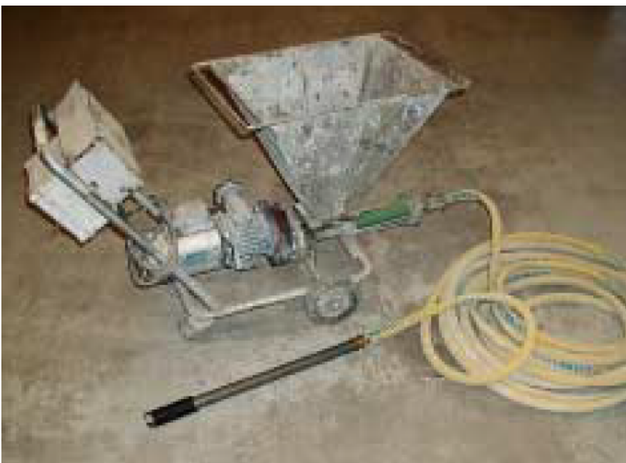
Kuva 14. Konepumppu ja injektointitulppa
