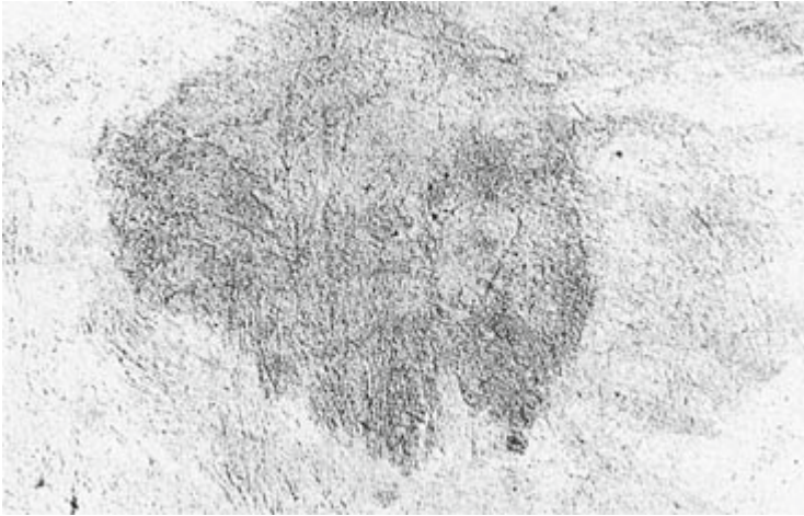
Kuva 7. Kuivasta pinnasta voidaan todeta, että haitallinen öljy on saatu poistetuksi
