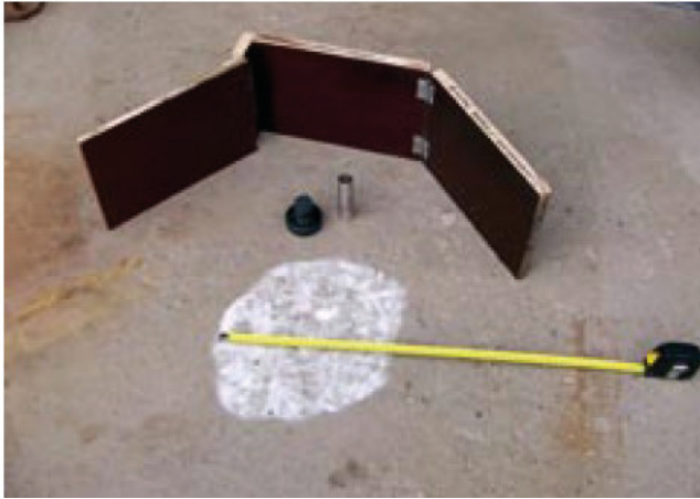
Kuva 15. Eristysalustan karheuden mittaus lasihelmien avulla (PANK 5103)
