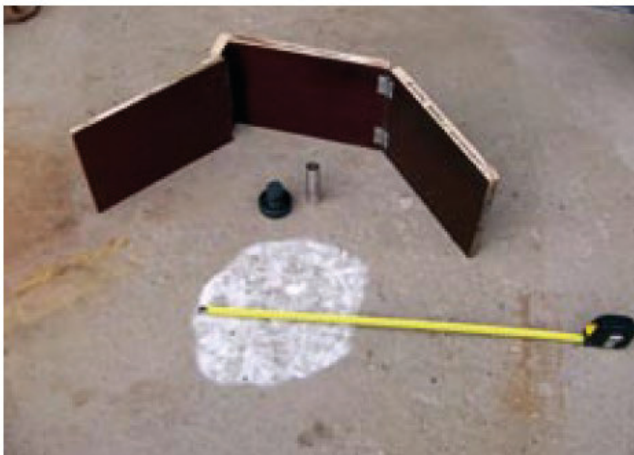
Kuva 16. Eristysalustan karheuden mittaus lasihelmien avulla (PANK 5103)
