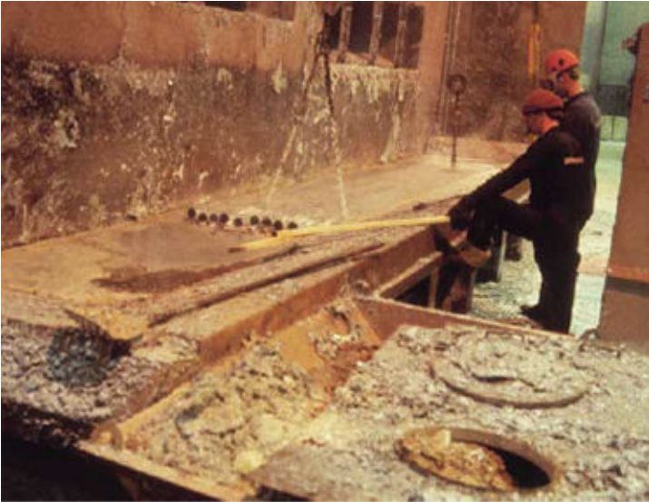
Kuva 7. Kuumasinkitysallas rajoittaa sinkittävän kappaleen kokoa
