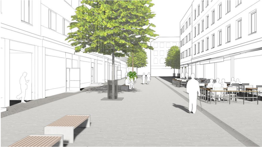
Kuva 80. Erilaiset materiaalit ohjaavat näkövammaista henkilöä. Esimerkiksi hulevesikourut voivat toimia ohjaavana elementtinä, kunhan ne eivät aiheuta kompastumisvaaraa, ja valkoinen keppi ei kulkeudu kaivon uraan.
