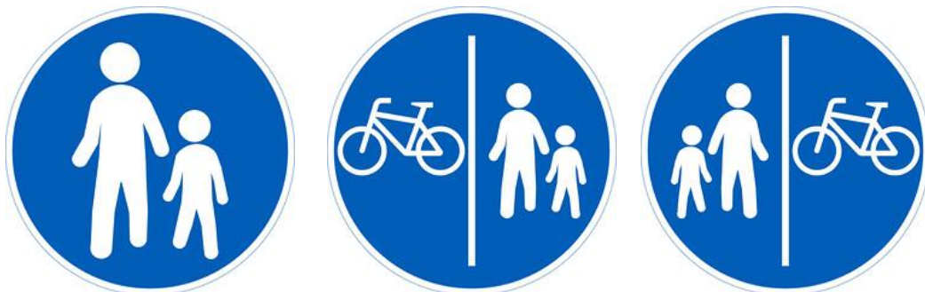
Kuva 25. Tieliikennelain mukaiset D4 Jalkakäytävä, D7.1 ja D7.2 Pyörätie ja jalkakäytävä rinnakkain liikennemerkkit.
