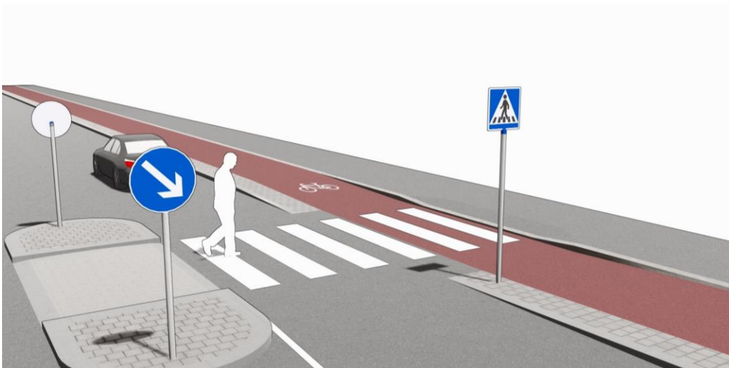
Kuva 49. Pyörätie voidaan laskea ajoradan tasoon suojatien kohdalla, jos odotustilaa ei ole mahdollista toteuttaa.
