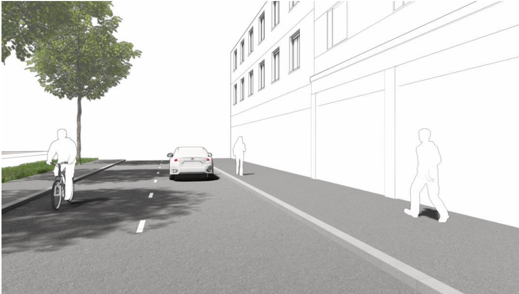
Kuva 24. Jalkakäytävä erotetaan rakenteellisesti ajoradasta.
