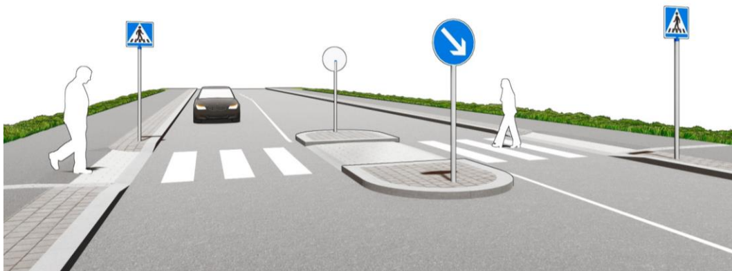
Kuva 79. Esteettömyyden erikoistason suojatien periaateratkaisu jalkakäytävän yhteydessä (soveltaen SuRaKu-kortteja).
