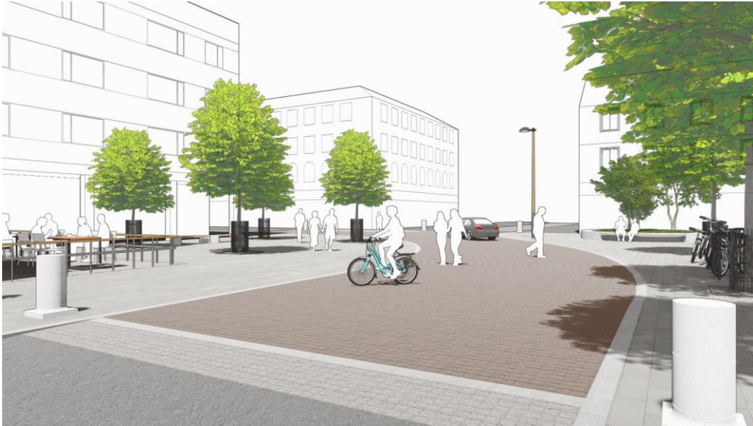
Kuva 61. Yhteisen tilan (shared space) periaatteella toteutetussa järjestelyssä liikennettä voidaan jäsentää pollareilla, päällysteillä ja kalusteilla.
