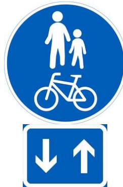
Kuva 28. Yhdistettyä pyörätietä ja jalkakäytävää osoittava liikennemerkki D6 ja lisäkilpi H23.2, joka osoittaa pyörätien kaksisuuntaisuuden.
