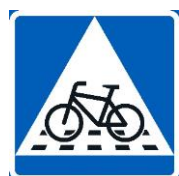
Kuva 51. Pyöräilijän tienylityspaikka merkitään pyörätien jatkeena (vasemmalla), jossa ajoneuvolle ja raitiovaunulle osoitetaan väistämismisvelvollisuus B5-, B6- tai B7-liikennemerkkeillä (oikealla).
