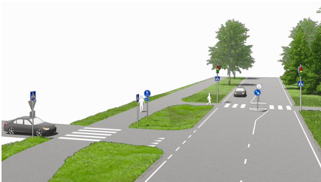
Kuva 44. Keskikorokkeellinen suojatie voidaan valo-ohjata vähintään 10 m etäisyydellä risteyksestä, jos risteuksen suunnasta on enintään kaksi ajokaistaa ja sivusuunnat ovat vähäliikenteisiä ja väistämisvelvollisia.
