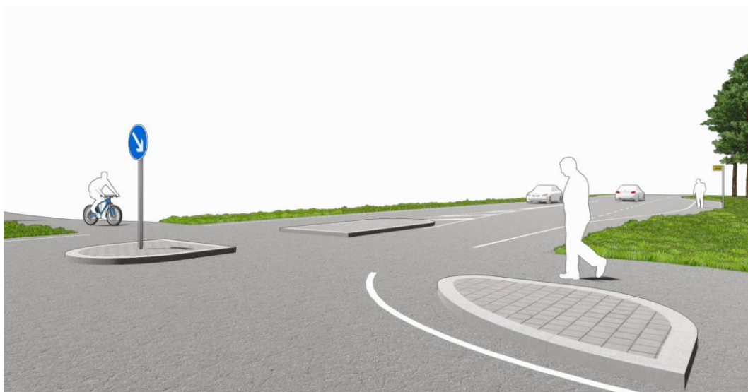
Kuva 52. Ajoradan rakenteellinen ylityspaikka keskisaarekkeella toteutettuna.
