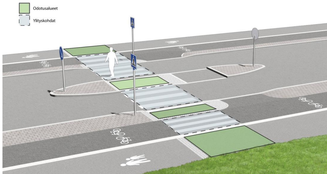
Kuva 77. Tien ylityksen jakautuminen ylityskohtaan saapumisen jälkeen odotusalueisiin ja ylityskohtiin.
