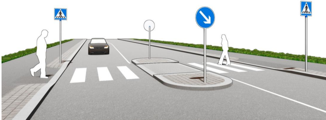
Kuva 78. Esteettömyyden perustason suojatien periaateratkaisu jalkakäytävän yhteydessä (soveltaen SuRaKu-kortteja).
