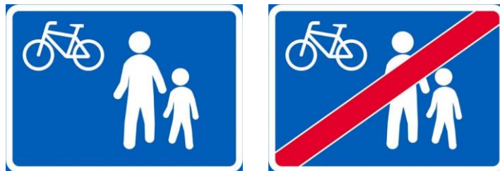
Kuva 32. Kävelykatu (E26) ja Kävelykatu päättyy (E27) -liikennemerkkit.
