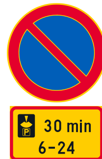
Kuva 156. Lisäkilven H19 (pysäköintiajan alkamisen osoittamisvelvollisuus) ja H17 (voimassaoloaika) käyttö samassa lisäkilvessä.
