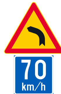
Kuva 128. Merkin F25 (enimmäisnopeussuositus) käyttö varoitusmerkin kanssa.
