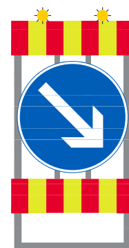
Kuva 161. Toimintaympäristöluokan S3 sulkuaita (I2.1 ja ylikokoinen D3.1).
