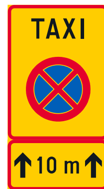
Kuva 58. Lisäkilven H3 (vaikutusalueen pituus) käyttö merkin C42 (taksin pysäyttämispaiikka) yhteydessä.
