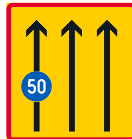
Kuva 77. Merkin D10 (vähimmäisnopeus) käyttö merkissä C36 (ajokaistakohtainen kielto, rajoitus tai määräys)
