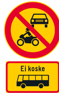
Kuva 40. Merkki C2 (moottorikäyttöisellä ajoneuvolla ajo kielletty) ei koske lisäkilven H12.2 (linja-auto) osoittamaa ajoneuvoryhmää.
