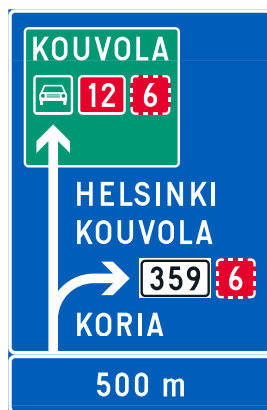
Kuva 111. Merkki F1.3, kun se sijoitetaan muualle kuin moottoriväylälle.
