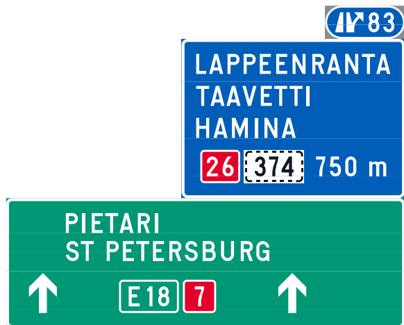
Kuva 138. Merkin F34 sijoitus ajokaistan yläpuolisessa viitassa F10.
