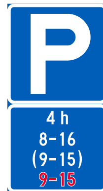
Kuva 146. Lisäkilpien H17 (voimassaoloaika) ja H18 (aikarajoitus) yhdistäminen samaan lisäkilpeen.
