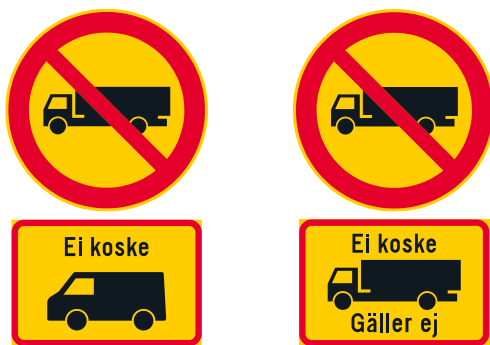
Kuva 42. Merkki C3 (kuorma- ja pakettiautolla ajo kielletty) ei koske lisäkilven osoittamaa ajoneuvoryhmää.
