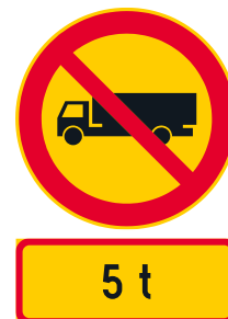
Kuva 41. Lisäkilven H24 (tekstillinen lisäkilpi) käyttö merkin C3 (kuorma- ja pakettiautolla ajo kielletty) yhteydessä.
