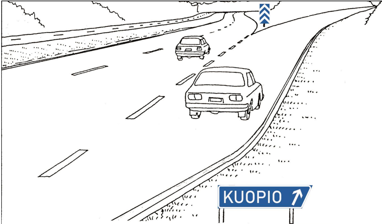
Kuva 167. Merkillä I11 (erkanemismerkki) osoitetaan erkanevan tien alkamiskohta.
