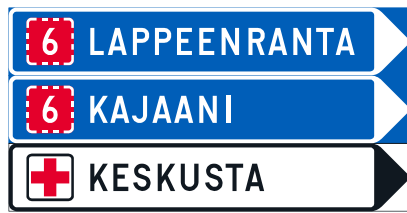
Kuva 123. Tunnuksat F35 (opastus numeron tarkoittamalle tielle) ja G9 (ensiapu) yhdistettynä tienviitteen.
