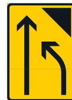
Kuva 116. Tilapäisissä liikennejärjestelyissä osoitetaan ajokaistan päättyminen pohjavärieltään keltaisella merkillä F8, jossa kaistan päättymistä korostetaan mustalla estettä kuvavalla kolmiolla.
