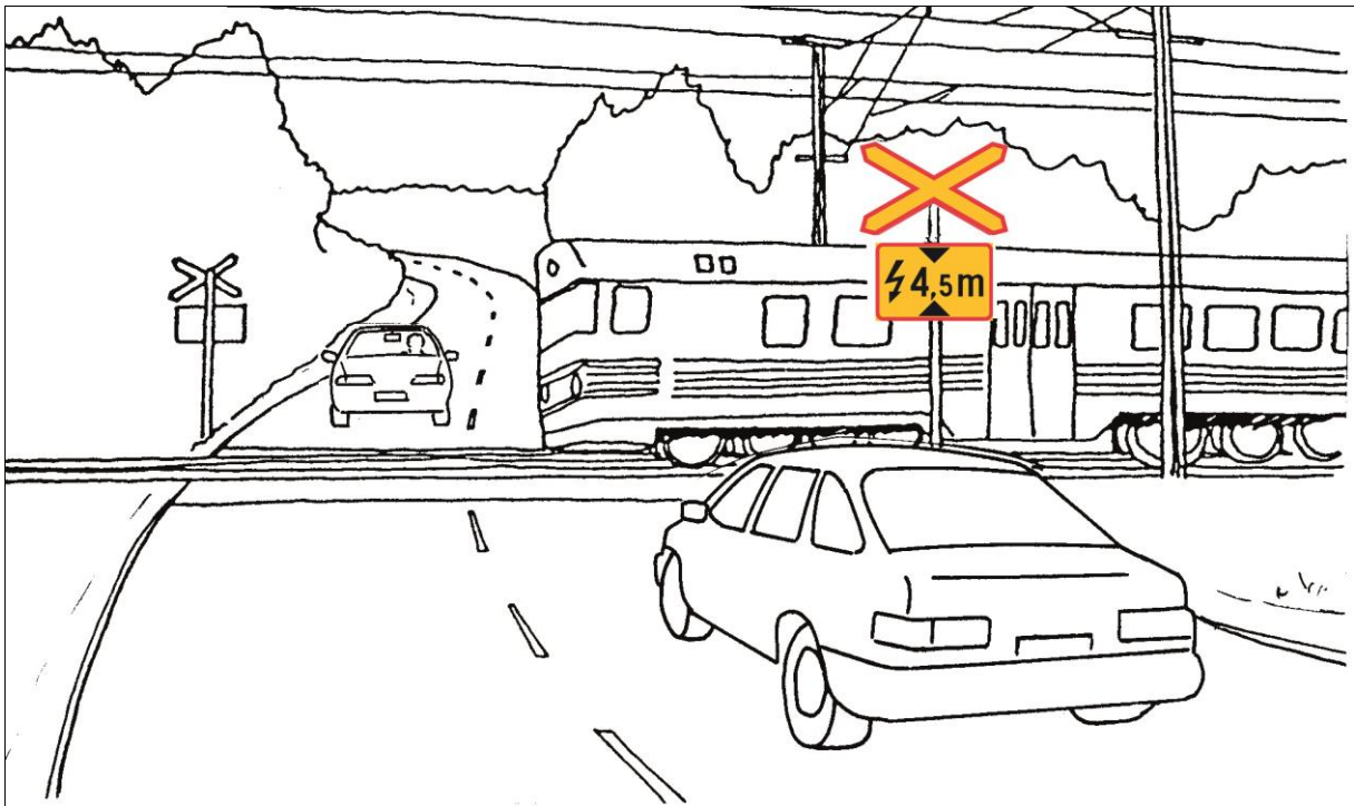
Kuva 150. Lisäkilpeä H8 (sähköjohdon korkeus) käytetään kaikissa tien ja sähköistetyin rautatien tasoristeyksissä.
