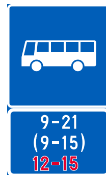
Kuva 91. Voimassaoloaika-lisäkilvien käyttö merkin E9 (linja-autokaista) yhteydessä.
