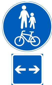
Kuva 151. Lisäkilven H9.1 (vaikutusalue molempiin suuntiin) käyttö merkin D6 (yhdistetty pyörätie ja jalkakäytävä) yhteydessä.
