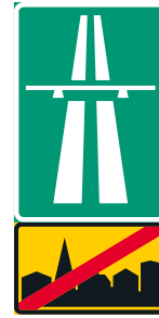
Kuva 95. Taajamasta moottoritielle johtavalle yksikaistaisella liittymistiellä merkki E15 sijoitetaan normaalikokoisena tien oikealle puolelle, yleensä pienikokoisen merkin E23 (taajama päättyy) kanssa samaan pylvääseen.
