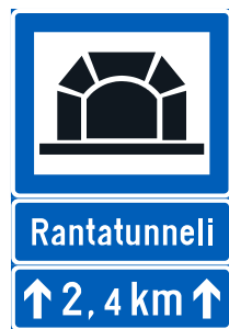
Kuva 100. Merkin E19 (tunneli) käyttö lisäkilpien H3 (vaikutusalueen pituus) ja H24 (tekstillinen lisäkilpi) kanssa.
