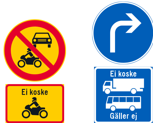
Kuva 153. Merkki C2 (moottorikäyttöisellä ajoneuvolla ajo kielletty) ei koske moottoripyöriä, merkki D1.4 (pakollinen ajosuunta) ei koske kuorma- eikä linja-autoja.
