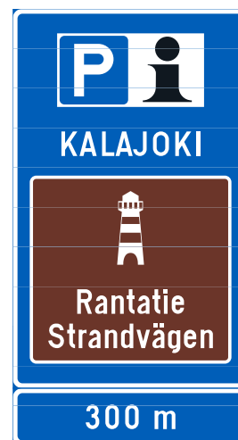
Kuva 145. Matkailutien yksilöllisen tunnuksen käyttö palvelukohteen opasteessa.
