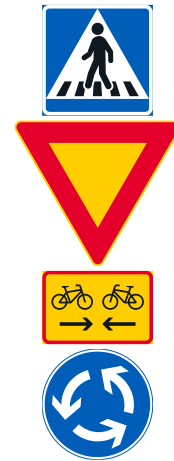
Kuva 79. Merkki E1 (suojatie) sijoitetaan aina ylimmäksi.
