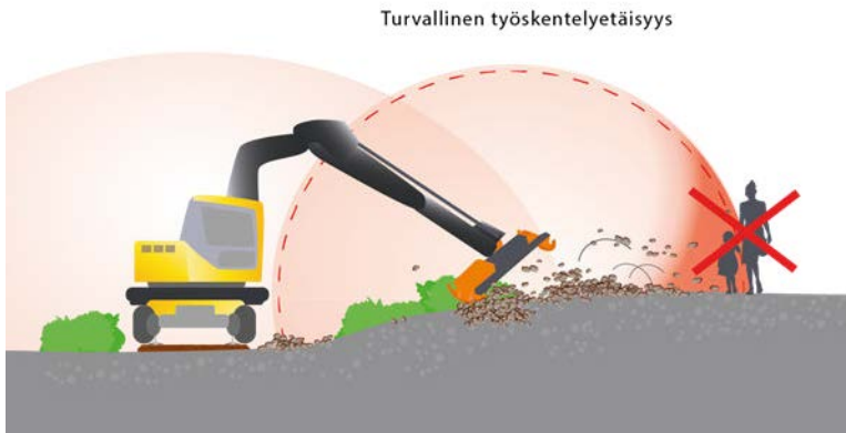
Kuva 3. Turvalliseen työskentelyetäisyyteen vaikuttaa mm. sinkoutuva materiaali
