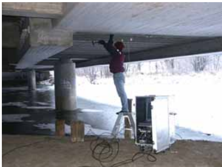
Kuva: Kotelon alapohjan poikittaisten Dywidag-tankojen jännevoiman mitaus kiihtyvyyssmittauslaitteiston avulla.
