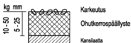
Kuva 14. Betoni-, teräs- tai puukantisen sillan ohutkerospäälyste.
