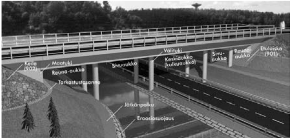
Kuva 7. Sillan alusrakenteet ja siltapaikan rakenteet.
