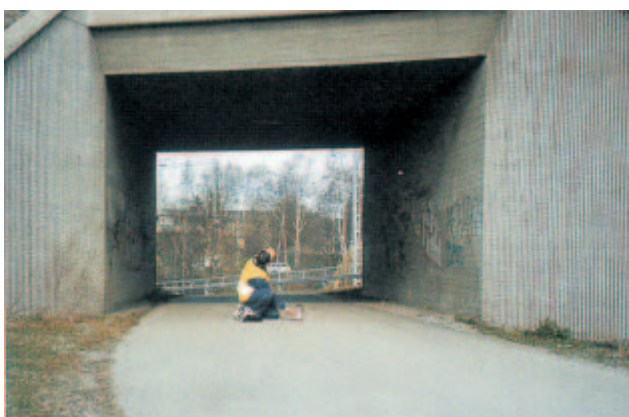
Kuva 46. Alikulkukorkeuden mittaaminen lasermittarilla.
