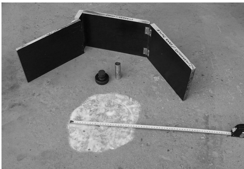
Kuva 3. Eristysalustan pinnan karkeuden mittausvälinesarja (Lasihelmet, mita-astia, levitystyökalu, metrimitta, tuulensuojus).
