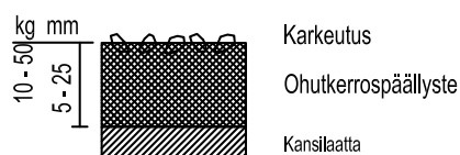
Kuva 14. Betoni-, teräs- tai puukantisen sillan ohutkerrospäällyste.
