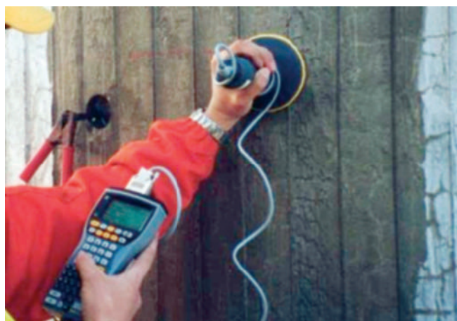
Kuva 59. Raudoituksen potentiaalimittaus tehdään betonin kostutetusta pinnasta.
