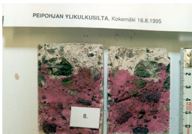
Kuva 57. Karbonatisoitumaton betoni värjäytyy punaiseksi, kun pintaan suihkutetaan fenoltaleinia.
