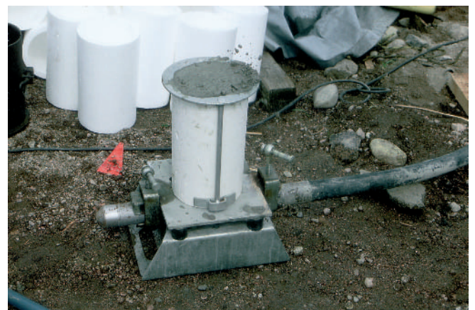
Kuva 61. Koekappaleen valmistusta työmaalla.
