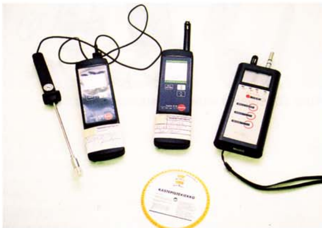
Kuva 56. Pintalämpömittari, pinta- ja ilmalämpömittari, yhdistelmämittari, jossa on lämpömittarien lisäksi kastepistelämpötila (°C) ja suhteellinen kosteus (RH %). Alimpana kastepistekiekkok.
