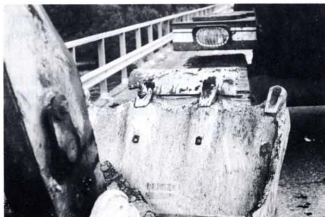
Kuva 25. Päällysteen poistoon sopiva kauha, jonka kynsiin on hitsattu teräslevy
