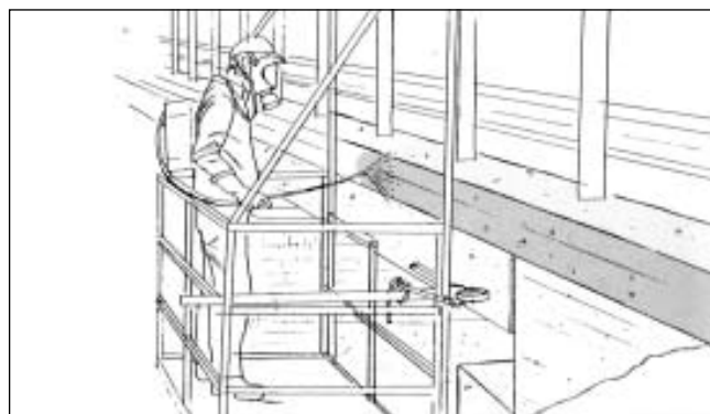
Kuva 18. Reunapalkin suojausta impregnoimalla.
