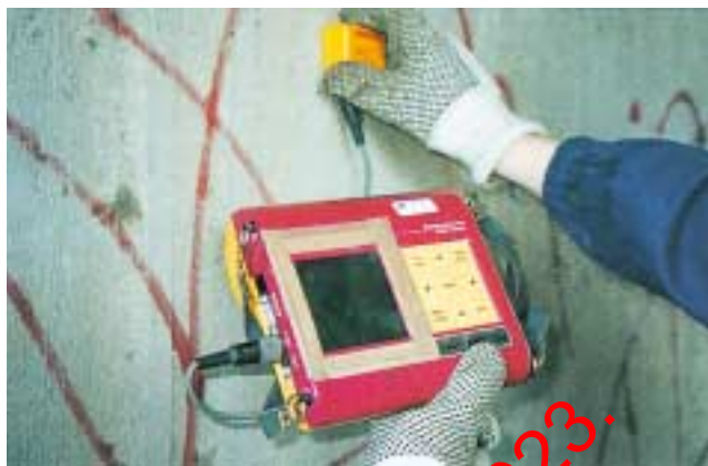
Kuva 5. Raudoitustankojen paikat määritetään.
