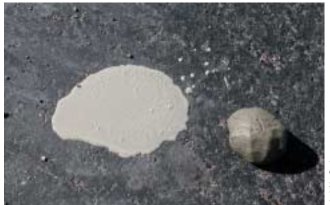
Kuva 4. Notkea juotoslaasti ja valumaton pakkauslaasti.
