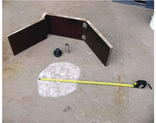
Kuva 18. Eristysalustan karheuden määrittäminen lasihelmimenetelmällä.
