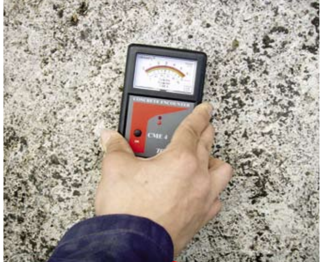
Kuva 15. Betonin absoluuttisen kosteuden mittaaminen.
