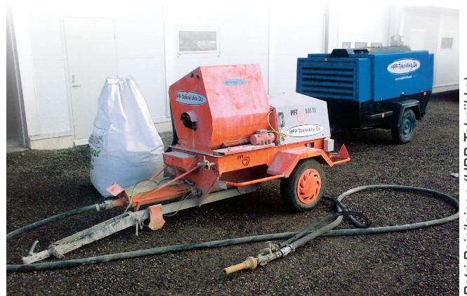
Kuva 6. Sementtipohjaisen pinnoitteen sekoituskalusto.
