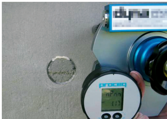
Kuva 14. Pinnoitteen tartunnan tarkastaminen vetokokeella.
