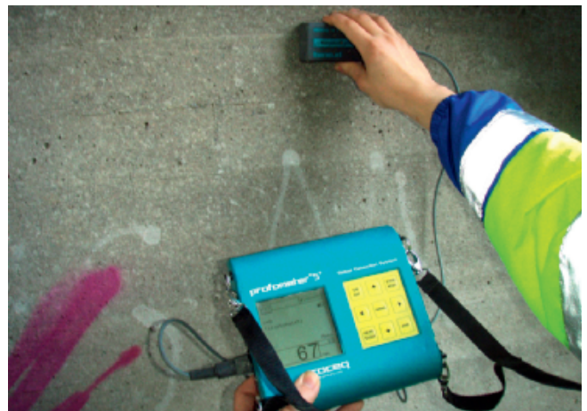
Kuva 4. Betoniterästankojen paikat määritetään betonipeitemittarilla.
