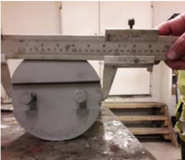
Kuva 19: Rullan pyöreyyden mittaus
